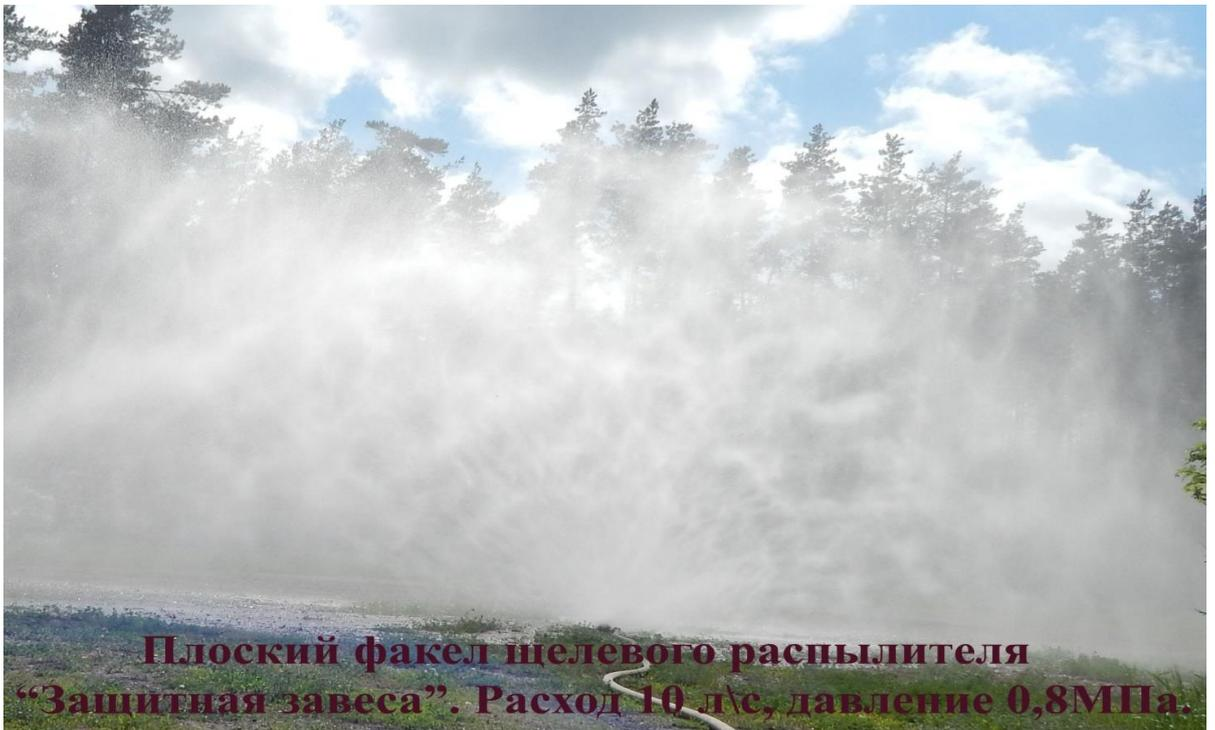
создание водяных секторных завес на пути распространения пожара
