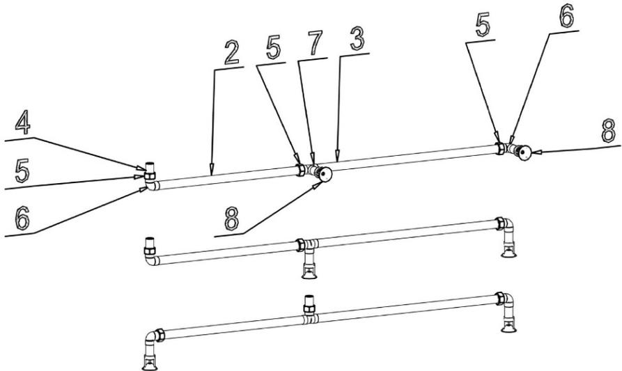
Рисунок 4 - Варианты монтажных схем направляющего трубопровода модулей Буран-15КДН или Буран-15КДТ
