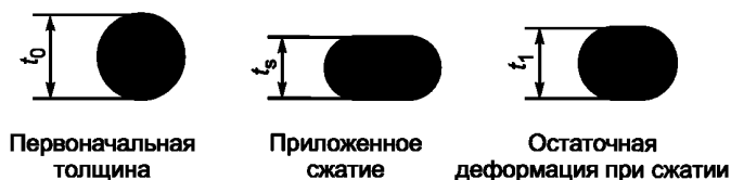
Рисунок 6 — Остаточная деформация при сжатии уплотнительного кольца
